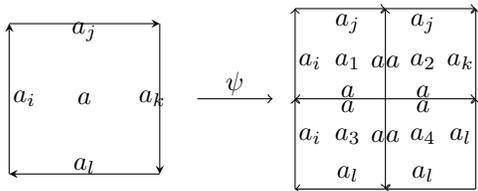
Смысл такой декорации в следующем: бесконечно декодируемое замощение состоит из блоков  $2^k \times 2^k$ , а каждый блок  $2^k \times 2^k$  – из четырёх блоков  $2^{k-1} \times 2^{k-1}$ , и границы между этими четырьмя блоками образуют крест, на рёбрах которого написана одна и та же буква. Эти кресты разграничивают блоки большого размера друг от друга. В примере с коврами Серпинского такой границы не было, и локальными правилами нельзя было отличить границу большого блока от его средней части.
